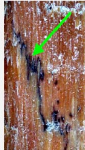
Lignes de démarcation noires dans le bois (formées par le champignon pour se protéger de la sécheresse et de la concurrence)
