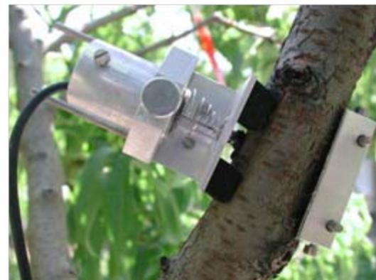
basées sur un indicateur plante : fluctuations micrométriques des troncs
