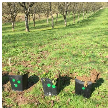
Figure 1 : A l'aide d'une bêche-plate (ou pelle-bêche) des échantillons d'environ 2-2.5Kg ont été prélevés (≈15x15x20 cm)
